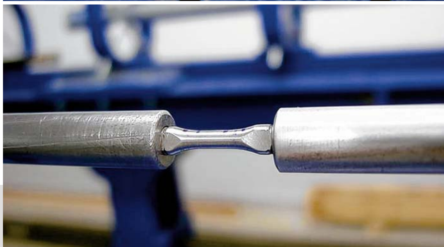
Alcuni campioni di calcestruzzo e acciaio testati nel DynaMat
