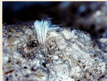
Micrografia di un fascio di fibre di amianto all'interno di un prodotto da costruzione
